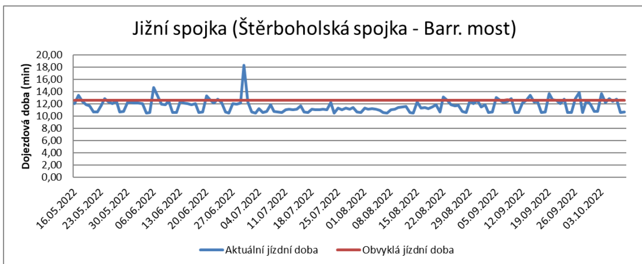
Obrázek 20: Průběh dojezdové doby na Jižní spojkě v úseku Štěrboholská spojka – Barrandovský most
